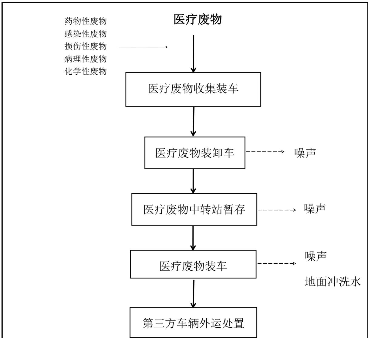
图 5-2 医疗废物收集中转站工艺流程图
