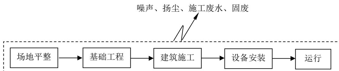
图 5-1 施工期流程及产污环节图
