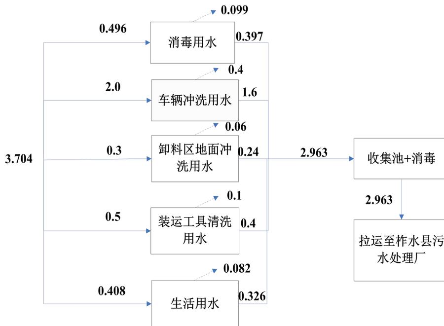
图 1-3 本项目水平衡图单位: m<sup>3</sup>/d
